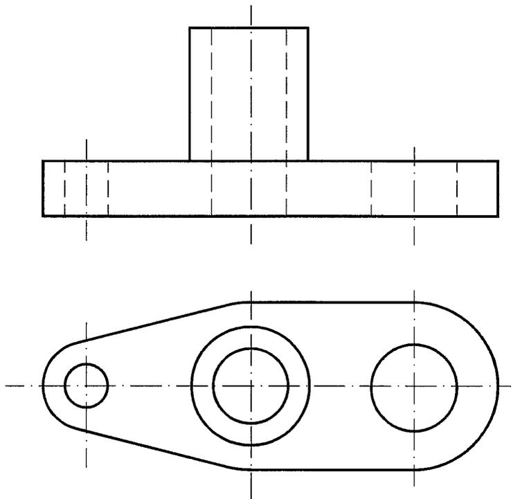
5.- CABALLERA. Representa en PERSPECTIVA CABALLERA, a escala 2:1, una figura correspondiente a las vistas dadas. El coeficiente de reducción del eje Y es  $\frac{2}{3}$ . La posición de los ejes es la indicada.
