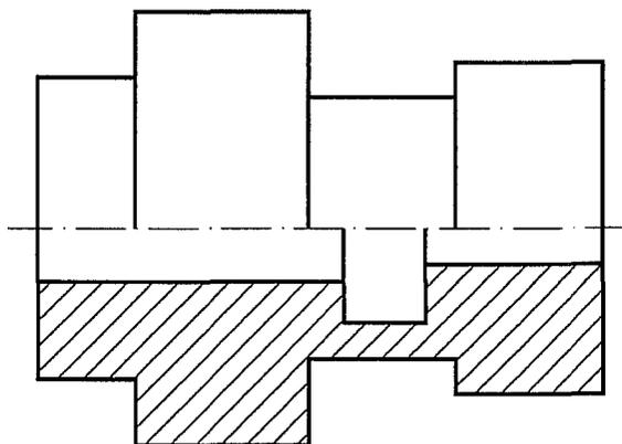
5.- ISOMÉTRICA. Representar en PERSPECTIVA ISOMETRICA, a escala 3:2, la figura correspondiente a las proyecciones dadas. Calcular gráficamente y aplicar en la representación los coeficientes de reducción. Dibujar el perfil correspondiente a la solución hallada.
